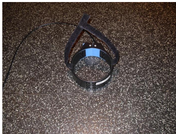
Coil Hallmarq utilisé pour un examen IRM du carpe ou du jarret
