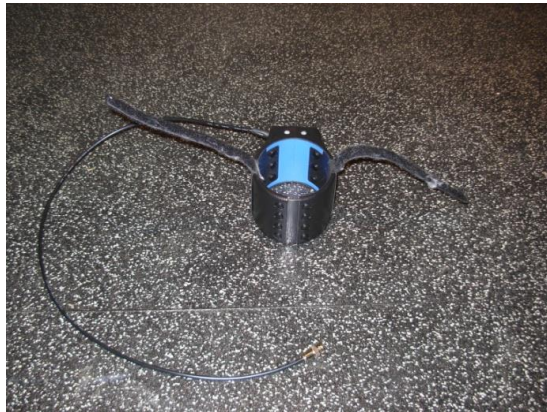
Coil Hallmarq utilisé pour l'examen IRM du boulet et du tendon
