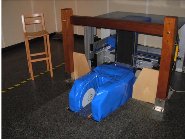
IRM bas champ 0.27 T de la société Hallmarq implanté à la Clinique Vétérinaire Equine de Livet
